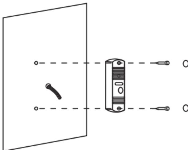
Рис. 5 Фронтальная установка вызывной панели LEGEND.
