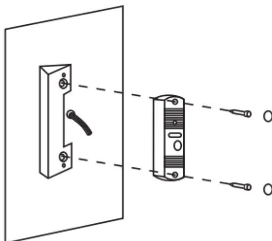
Рис. 6 Установка вызывной панели LEGEND под углом 30°.
