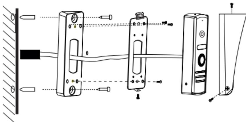
Рис. 8 Установка вызывной панели MASK под углом 30°.
