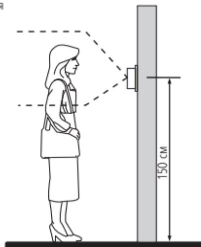
Рис. 4 Рекомендуемая высота установки видеопанели.
