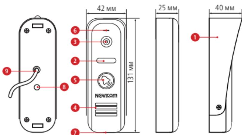
Рис. 3 Вызывная панель MASK.
