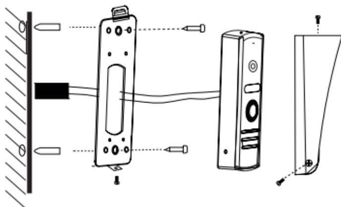
Рис. 7 Фронтальная установка вызывной панели MASK.
